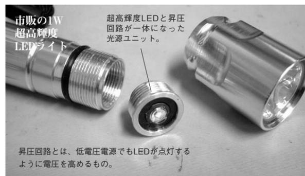
昇圧回路とは、低電圧電源でもLEDが点灯するように電圧を高めるもの。
