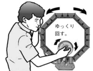
5 ダイオードで聴くことができれば、バリコンを動かさずに鉱石に替えて実験してみよう。
