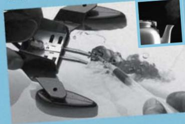
ボートが走っているとき、うしろのくだを少し持ち上げて、水を入れたコップを近づけてみよう。コップに水のつぶがついたね。そう、くだから出ているのは、水じょう気だ。ボートは、じょう気のかで走るんだ。
